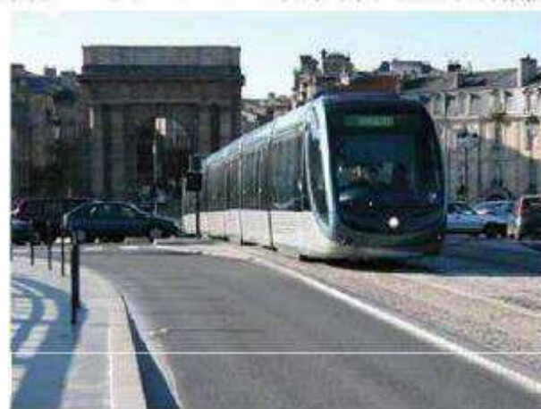
写真2 ボルドーの架線レス車両 (2003年12月撮影)
