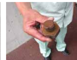
屋根トラスのボルトが破断し落下。
