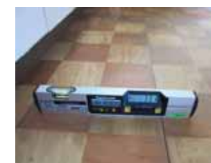
貯水池脇でがけに向かって沈み込み、基礎の下の土が絡げ取られている借家。室内では床に30°の傾斜がついている。
